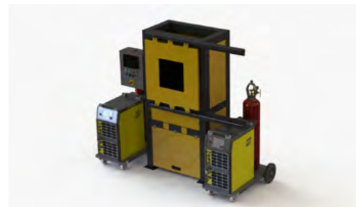
MINI ROBÔ DE SOLDA DE GARFOS - TRIPLICOU A PRODUTIVIDADE.
